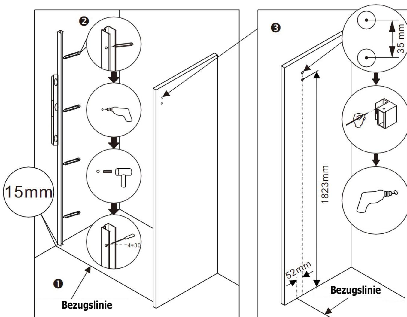
1. Verbinden Sie das Glas-Aluminium-Profil und die Aluminium-Führungsschiene mit zwei 4\*30 Schrauben.
