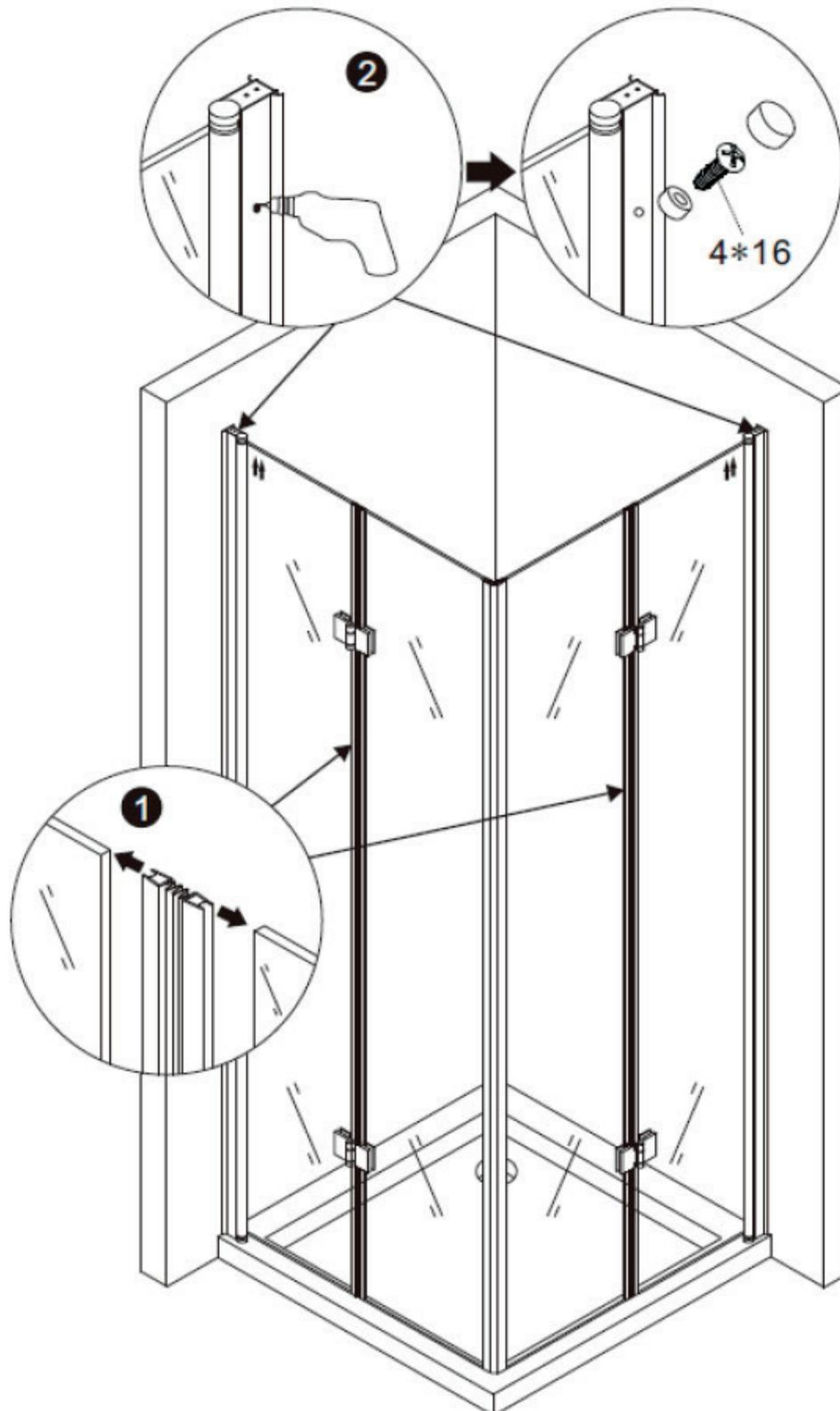
Installieren Sie die Aluminium Dichtung wie auf dem Bild zu sehen, mithilfe der Kunststoffhalterungen auf der Wanne. Spritzen Sie das Silikon unter die Dichtung (siehe Bild)
