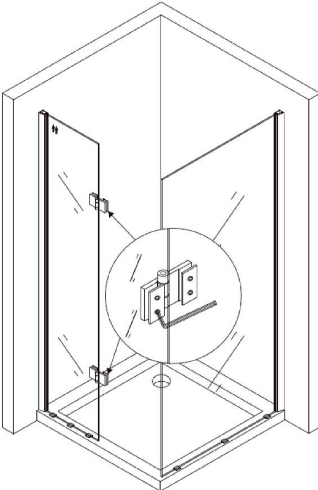
Befestigen Sie die Glastüren durch die Scharniere, setzen Sie die Magnet- und Gummileisten an die Glaselemente, wie unten auf dem Bild gezeigt.
