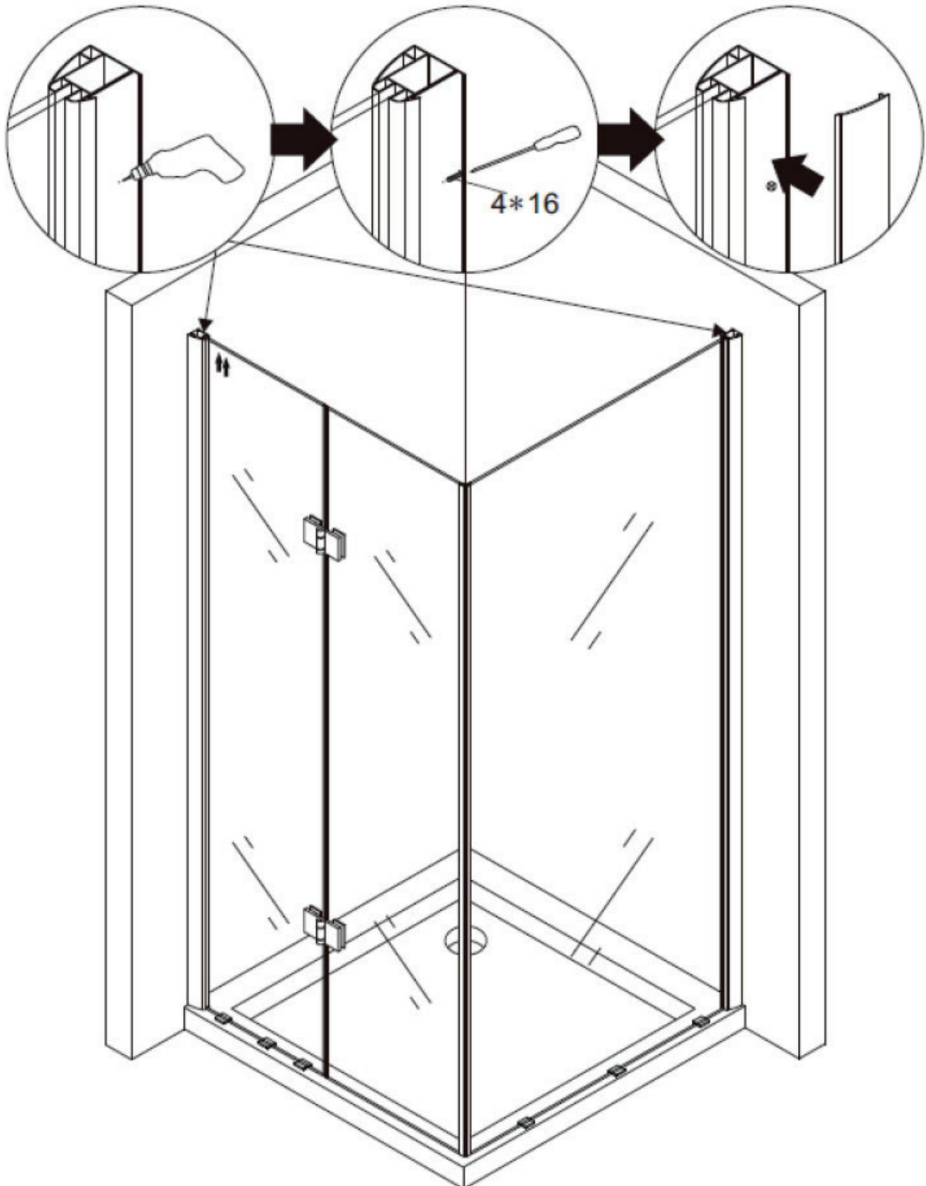
Installieren Sie die Aluminium Dichtung wie auf dem Bild zu sehen mithilfe der Kunststoffhalterungen. Spritzen Sie das Silikon unter die Dichtung (siehe Bild)
