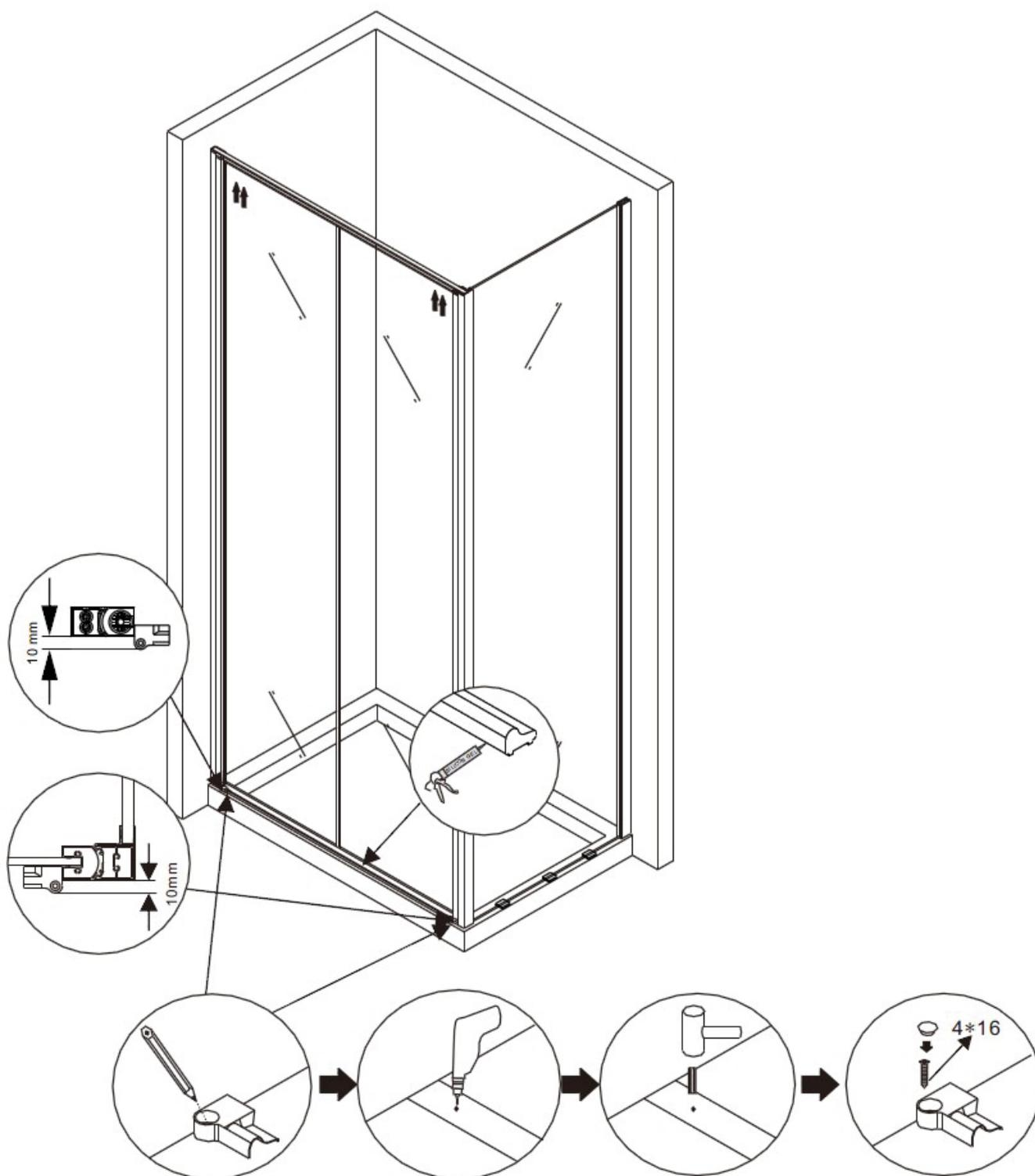
1. Befestigen Sie die Aluminium Schiene und das Profil der Glastür mit den 4x16 Schrauben.
