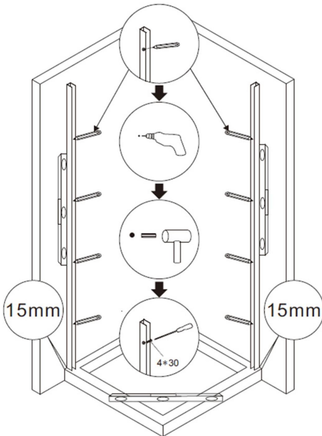
Verwenden Sie die 4x30 Schrauben, um die oberen und unteren Aluminiumschienen mit dem Aluminiumprofil zu verbinden (s. Abbildung)
