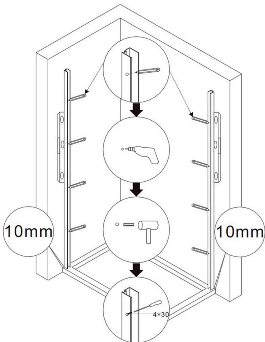
1. Verbinden Sie die Führungsschiene und das Aluminium Profil des festen Glaselements mit 4 \* 20 Schraube.
