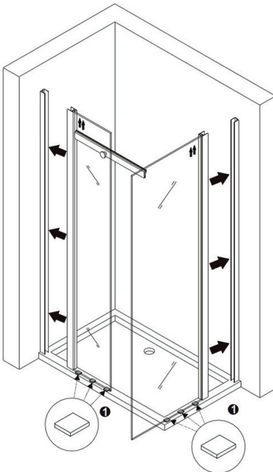
1. Montieren Sie die Verbindung um die Führungsschiene zu befestigen, wie auf dem Bild (1) unten gezeigt.
