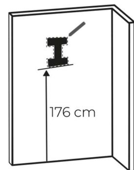
3. Reinigen Sie dann die so angezeichnete Fläche, auf der die Halterung später aufgeklebt werden soll mit dem beiliegenden UV-Primer Stift. Die Flüssigkeit wird dabei über den "Filz-Pinsel" aufgetragen. **ACHTUNG! Vermeiden Sie Kreisbewegungen.** Benutzen sie den Stift immer horizontal oder vertikal in Richtung der angezeichneten Außenränder.
