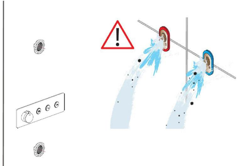
**Hinweis:** Vor der Installation Verunreinigungen in der Wasserleitung durch Spülen entfernen. Der Anschluss für heißes Wasser muss links und für kaltes Wasser rechts installiert werden. Achten Sie auf waagerechten Einbau. Die beiden hinteren Anschlüsse können nach unten als auch nach oben erfolgen.
