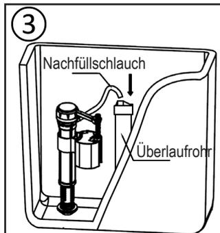
3. Stecken Sie das Nachfüllrohr in das Überlaufrohr.
