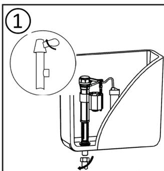
1. Drehen Sie die Wasserleitung zu und schrauben die Zuleitung ab.
