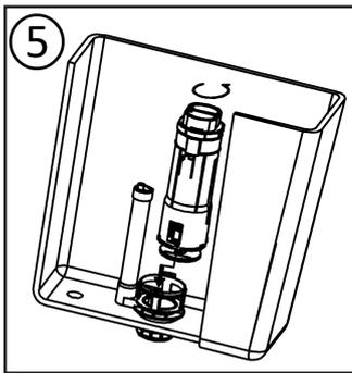
5. Setzen Sie die Hebeglocke in die Halterung. (Gemäß Abbildung)
