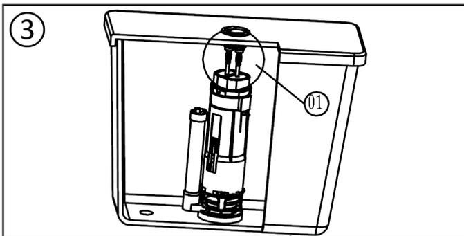
3. Drehen Sie das Ventil so, dass die Stange für die halbe Spülmenge über C und die Stange für die volle Spülmenge über B sitzt. (Gemäß Abbildung)
