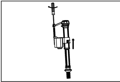
Um den Pegelstand zu erhöhen: Drehen Sie die Schraube im Uhrzeigersinn, um den Wasserbecher und Schwimmer auf die gewünschte Position zu erhöhen.
