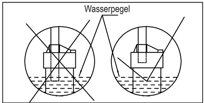
Stecken Sie den Nachfüllschlauch in das Überlaufrohr. Der Nachfüllschlauch darf nicht niedriger sein als der Wasserpegel.
