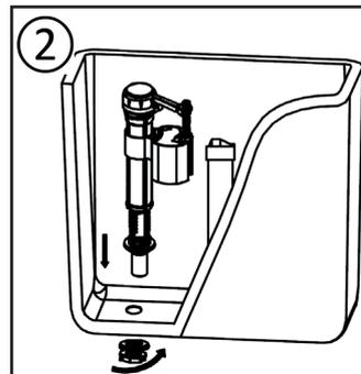
2. Setzen Sie das Füllventilrohr in die Öffnung im Spülkasten und stecken von unten die Dichtungen über das Gewinde. Anschließend schrauben Sie das Füllventil mit Hilfe der Mutter fest.
