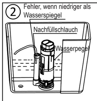
2. Falsche Installation: Der Nachfüllschlauch ist niedriger als der Wasserspiegel.
