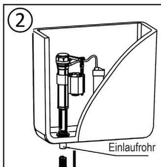
2. Nehmen Sie den Filter aus dem Einlaufrohr.
