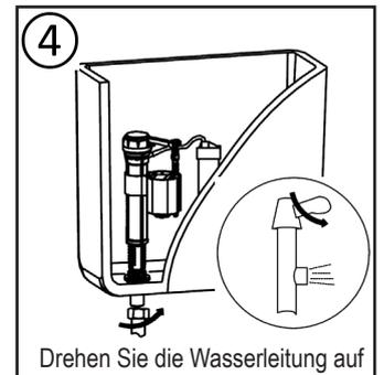
4. Verbinden Sie das Füllventil mit der Wasserleitung. Verwenden Sie hierzu am besten einen Panzerschlauch. Drehen Sie die Wasserleitung auf.
