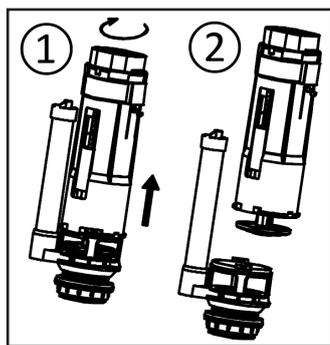
1 & 2. Nehmen Sie die Hebeglocke aus der Halterung. (Gemäß Abbildung)
