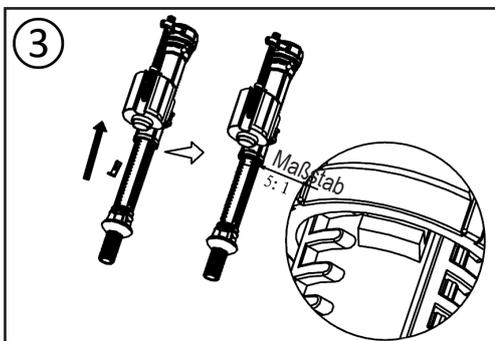
3. Setzen Sie den Stopper ein. (Gemäß Abbildung)
