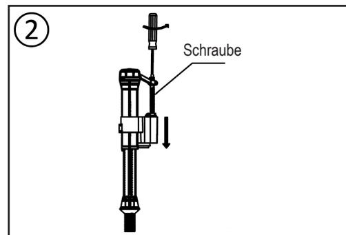
2. Um den Pegelstand zu senken: Drehen Sie die Schraube gegen den Uhrzeigersinn, um den Wasserbecher und Schwimmer auf die gewünschte Position zu senken. (Hinweis Schwimmeranleitung)
