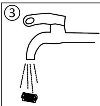
3. Spülen Sie das Filtersieb unter fließendem Wasser aus.
