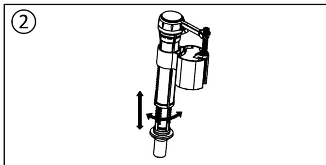
2. Drehen Sie das Füllventil gegen den Uhrzeigersinn lose und drücken Sie nach oben oder ziehen nach unten, um die gewünschte Höhe zu erreichen. Anschließend drehen Sie das Füllventil mit dem Uhrzeigersinn fest.
