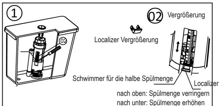
1. Drücken Sie den Localizer mit einem Schlitzschraubenzieher nach unten und justieren den Schwimmer für die halbe Spülmenge. (Gemäß Abbildung)
