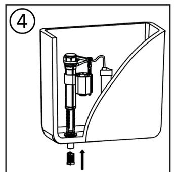
4. Setzen Sie den Filter wieder in das Einlaufrohr ein.
