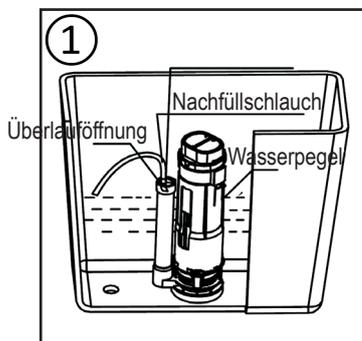
1. Korrekte Installation: Der Nachfüllschlauch ist höher als der Wasserspiegel.
