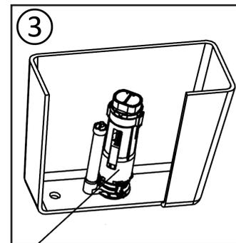
3. Halterung und Hebeglocke passen nicht richtig zusammen. Entfernen Sie bitte die Hebeglocke und setzen diese erneut in die Halterung.
