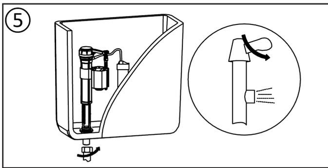
5. Verbinden Sie den Spülkasten mit der Zuleitung und drehen das Wasser auf.
