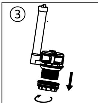
3. Drehen Sie die Mutter ab und ziehen die Unterlegscheibe und Kunststoffscheibe ab. (Gemäß Abbildung)
