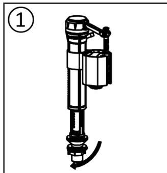
1. Drehen Sie die Mutter ab und entfernen die Gummi- und Plastikdichtung.
