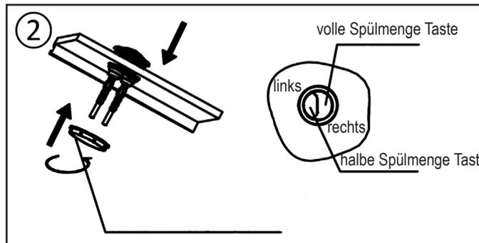
2. Setzen Sie die Betätigung in die Öffnung im Deckel und befestigen diese mit der Mutter.
