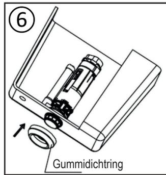
6 & 7. Stecken Sie die Gummidichtung von unten gegen den Spülkasten (Gemäß Abbildung). Prüfen Sie das alles fest verschraubt ist.
