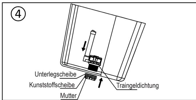
4. Setzen Sie die Halterung der Hebeglocke in den Spülkasten ein und befestigen diese mit der Mutter. Beachten Sie, dass die Traingeldichtung innen im Spülkasten sitzt. Die Unterlegscheibe und Kunststoffscheibe werden zwischen Mutter und Spülkasten platziert. (Gemäß Abbildung)
