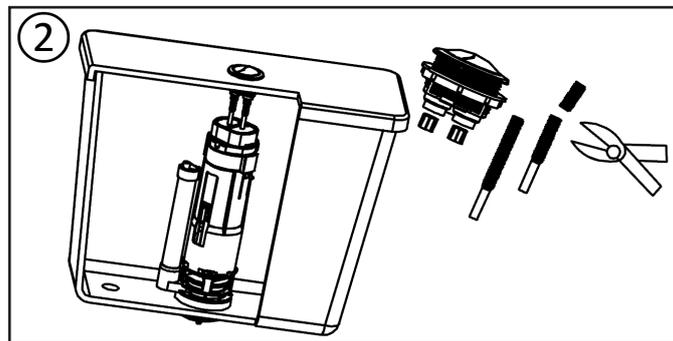
2. Drückerstange ist zu lang. Kürzen Sie die Stange, in dem Sie am Ende ein Stück abschneiden.
