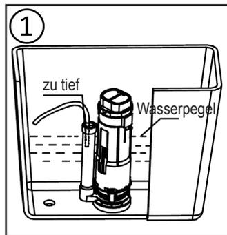
1. Justieren Sie den Nachfüllschlauch und vergewissern Sie sich, dass das Ende über dem Wasserspiegel liegt.
