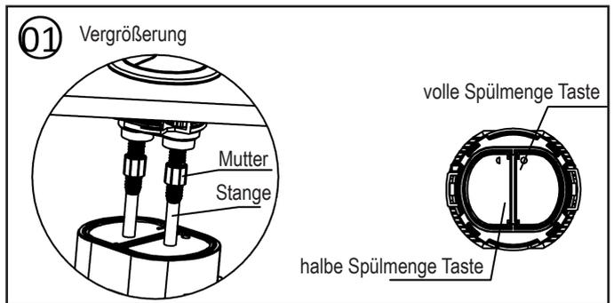
01. Drehen Sie die Mutter um die Länge der Stangen anzupassen, bis diese auf Hebeglocke aufliegen.
