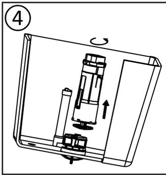
4. Schlechte Wasserqualität: Entfernen Sie die Hebeglocke und reinigen diese.
